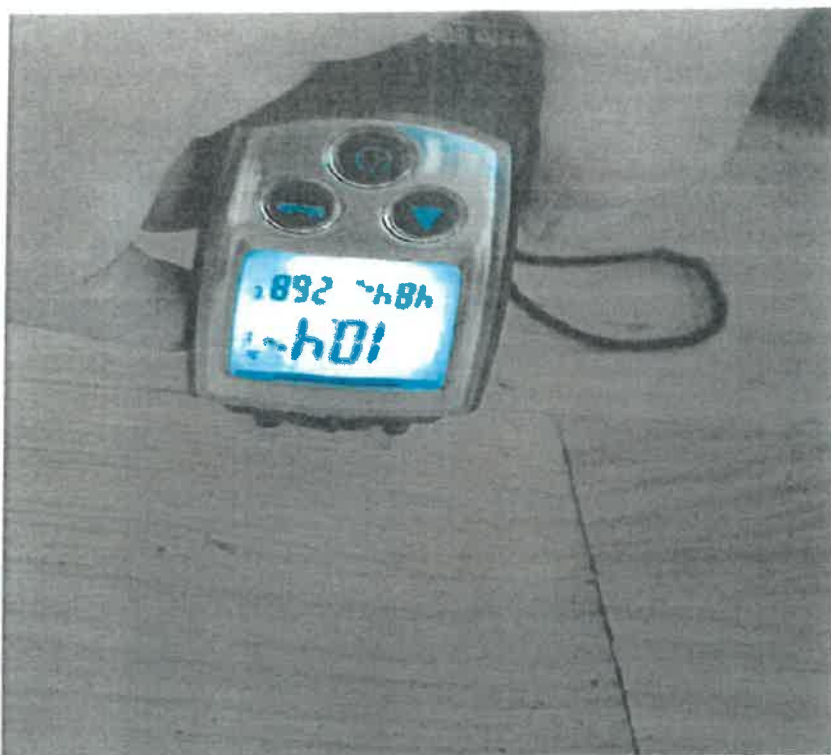
Fotografia nr 70 – Pomiar wilgotności drewnianych trójwarstwowych paneli podłogowych w pomieszczeniu nr 102. Wilgotność paneli W_{\text{panelu}} = 10,4\% . Dokonano pomiaru wilgotności zewnętrznej warstwy panelu.
